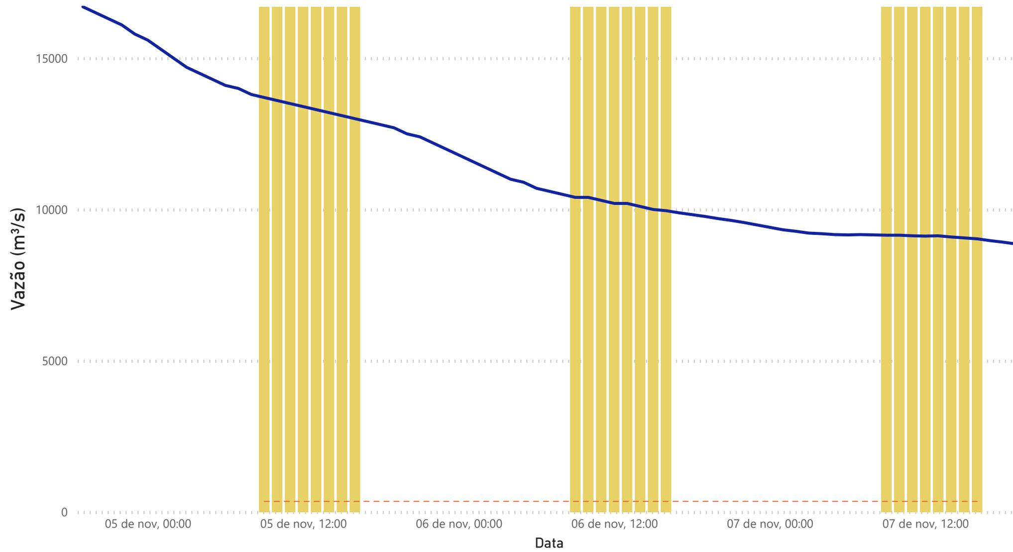
● Horário de Funcionamento ● Vazão (m³/s) ● Vazão Cênica
