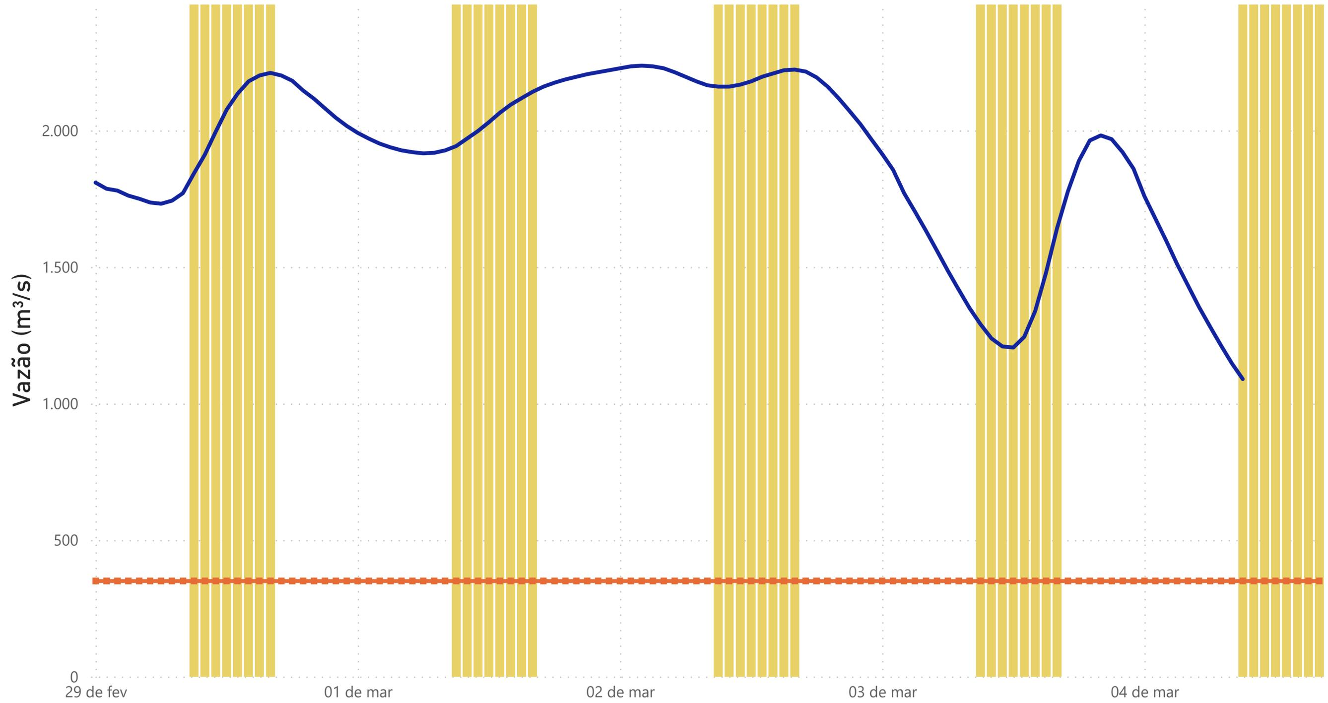
● Funcionamento do Parque Nacional do Iguaçu (das 9h às 16h) ● Vazão (m³/s) ■ Vazão mínima para beleza cênica (350 m³/s)
