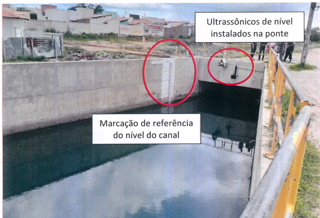
Figura 2 – Seção de medição em Monteiro: canal de seção retangular de concreto.
