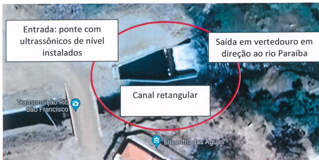
Figura 1 – Vista superior da seção de medição em Monteiro: o canal de concreto de seção retangular (trapezoidal ao longo de sua extensão).
