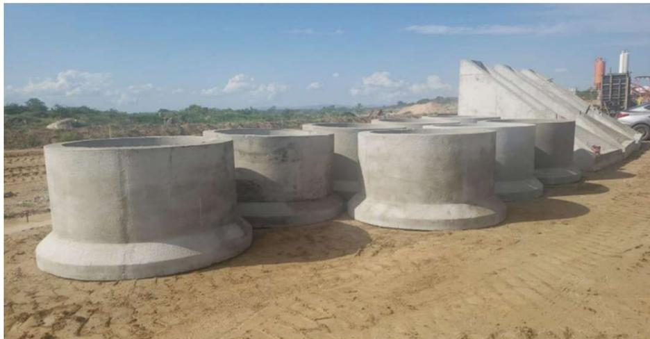
Usina de Concreto Canal C-7: Execução da fabricação das manilhas
