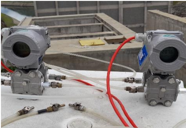
Sensores de pressão: recebem sinal do Pitot e do ultrassônico
