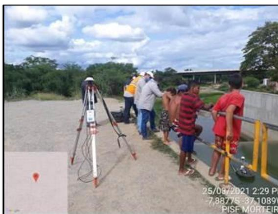
Figura 03 - Base RTK de correção de dados
