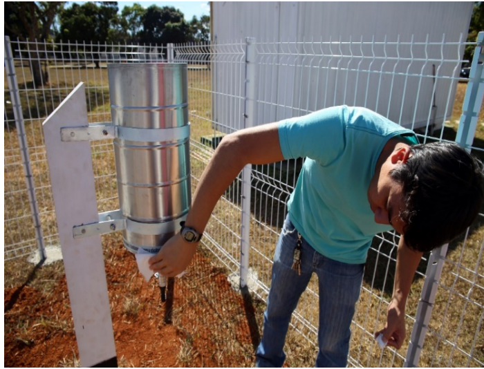
Figura 16: Detecção de vazamentos com um papel seco
