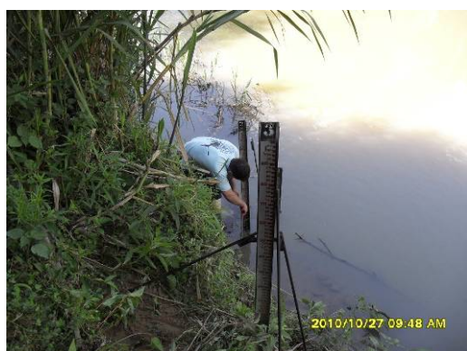
Figura 42 - Implantação de travamento de lance de régua
