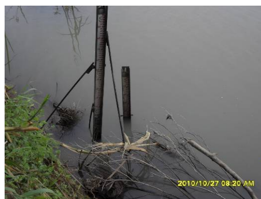
Figura 42 - Implantação de travamento de lance de régua
