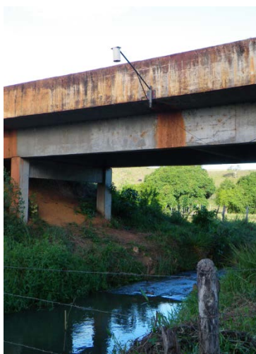
Figura 5- Sensor de radar instalado numa ponte.
