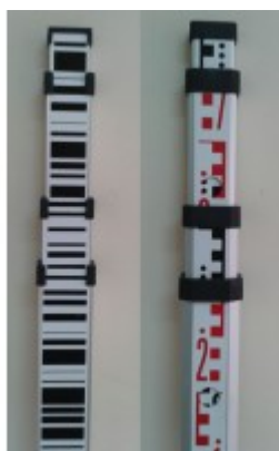
Figura 9 - Mira Falante com régua de código de barras e de escala numérica
