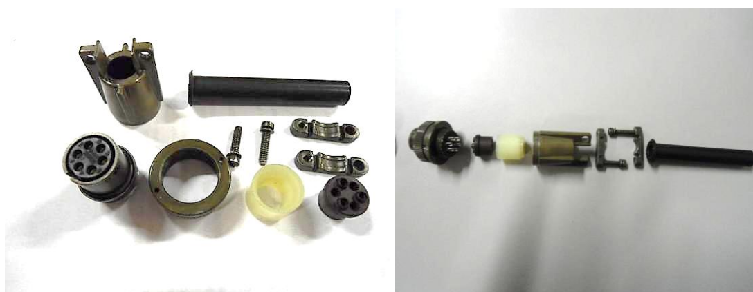
Figura 24 - Montagem correta do Conector Militar - Radar
