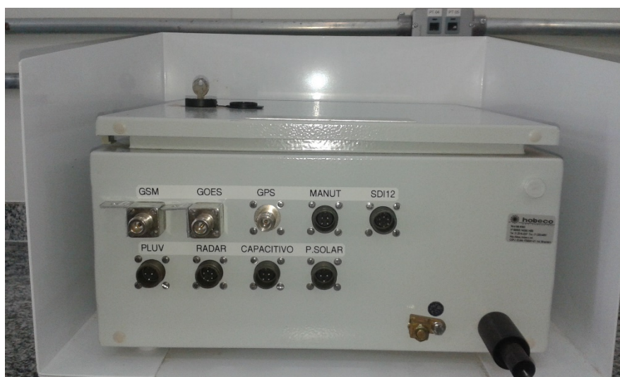
Figura 2- Foto dos conectores na PCD
