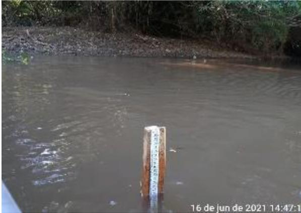
Figura 10: Régua instalada no Ponto 11, no dia 16/06/2021, início do processo de redução da vazão.
