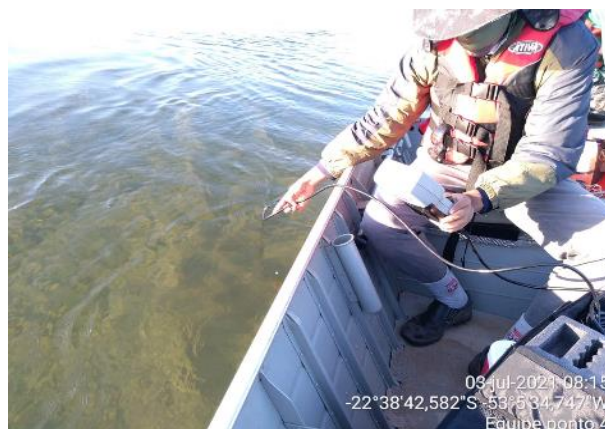
Figura 10 – Monitoramento da qualidade de água no Ponto 4, em 03/07/2021. Coordenadas: 22°38'42,58"S, 53°05'34,74"O.
