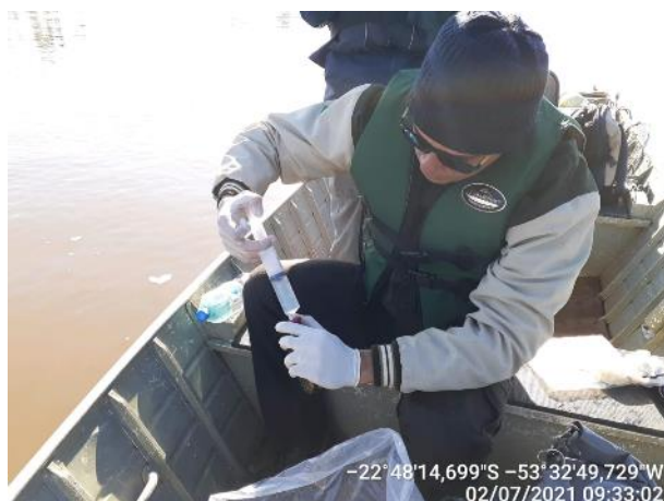
Figura 55 – Coleta de amostras de água para as análises físico-químicas e biológicas nos pontos 7 a 11, em 02/07/2021. Coordenadas: 22°48'14\"S, 53°32'49\"O
