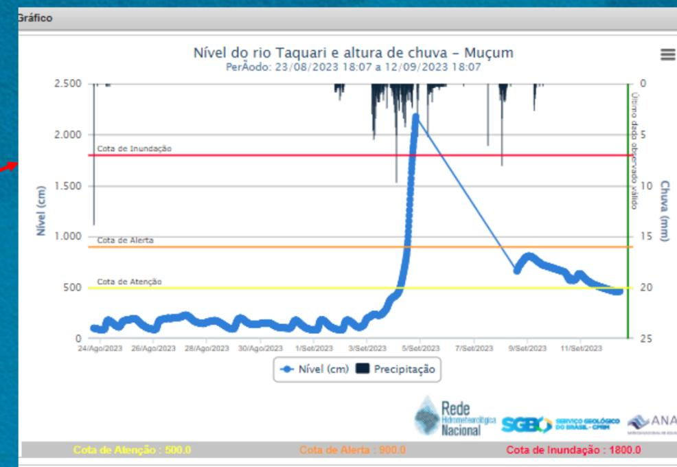
Muçum: realizado levantamento da marca de inundação = 26,11m
