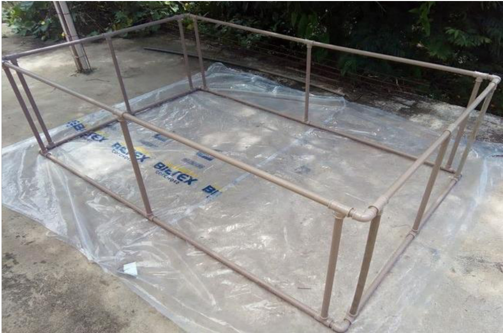
Figura 7: Modelo ilustrativo da tenda elaborada com tubo em PVC
