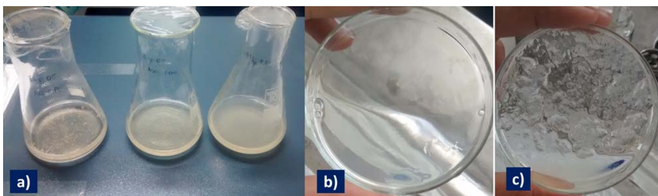
Figura 1 - a) da formação de precipitados e diferentes turbidez apresentadas durante os procedimentos de clarificação e dos resultados do teste qualitativo para pectina b) após e c) antes a clarificação.
