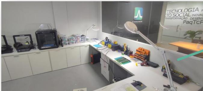
Lab. de eletroeletrônica pensado para o ambiente criativo, dispendo de modernos recursos de solda e retrabalho, ferramental, dispositivos analíticos e maquinário para usinagem de circuitos eletrônicos
