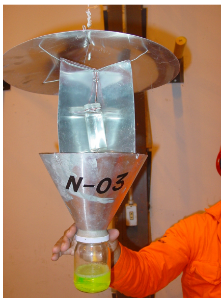
Figura 5. Armadilha de impacto tipo Escolítídeo/Curitiba, usada no monitoramento das pragas de embalagens de madeira.
