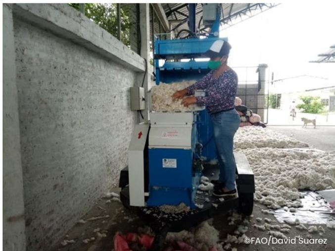
El equipo anterior cuenta con una mini desmotadora para separar la fibra de la semilla, y una prensa estándar para formar las pacas de algodón. Las pacas de algodón deben estar cubiertas de tela de algodón en su totalidad y sujetas con sunchos de plásticos y alambre. El proceso de prensado del algodón fibra se realiza por varias ocasiones hasta lograr una de paca de 80 kg a 100 kg.
