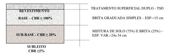
Seção de pavimento flexível adotada (acostamento)
